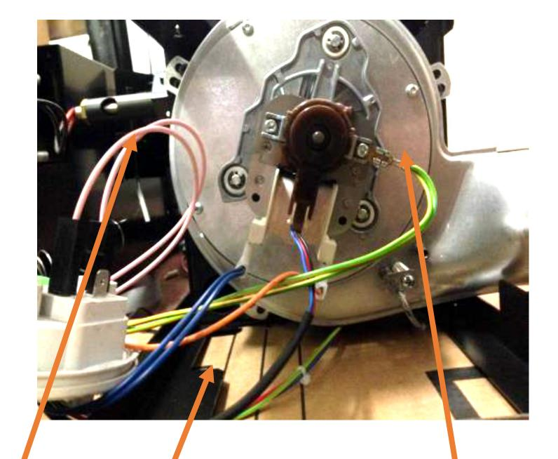
UNSCREW THE 3 SCREWS THAT FIX THE SMOKE'S MOTOR TO THE FURNACE AND REMOVE THE MOTOR
