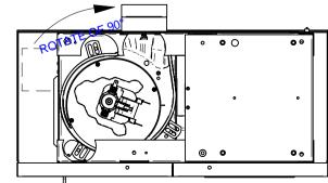
ROTATE THE MOTOR
